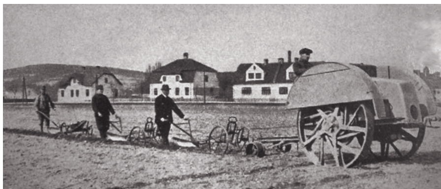
Das Daimler-Pferd konnte eine ganze Reihe von Pflügen ziehen. Allerdings musste jedes angehängte Gerät von einer Person gelenkt werden.
