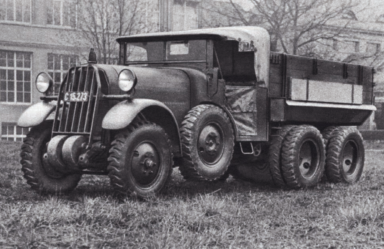
Der Geländelastwagen Austro Daimler ADGR befand sich von 1936 bis 1940 in Produktion. Er besaß einen 72 PS starken Sechszylindermotor und konnte mit einer Nutzlast von drei Tonnen aufwarten.
