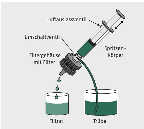
● Abb. 2.24 Filtration kleiner Chargen mittels Spritzenvorsatzfilter
