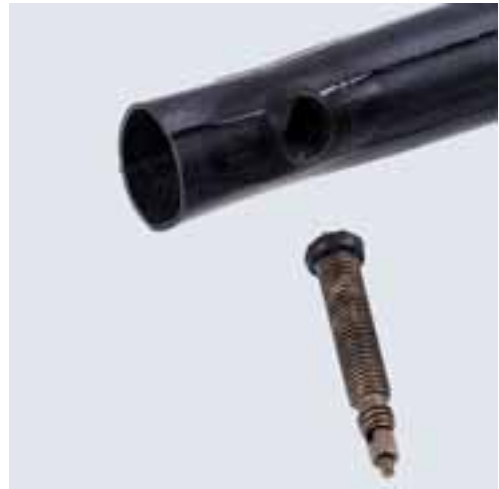
Hier hat ein zu großes und zudem scharfkantiges Ventilloch in der Felge das Ventil aus dem Schlauch gestanzt.
