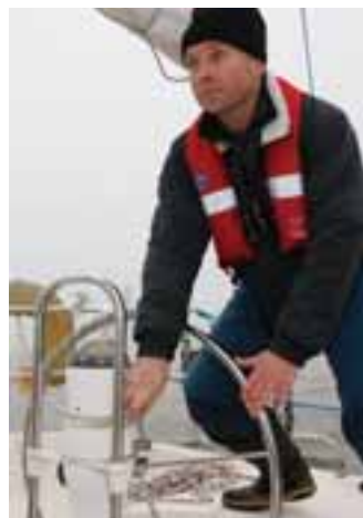
Rückwärtsschub, dann vorwärts, Ruder hart Backbord, dann hart Steuerbord, so kann sich der Kiel ausgraben - sofern man nicht auf Felsgrund liegt.
