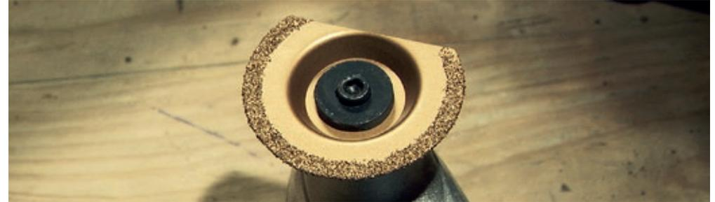
**TIPP:** Bringen Sie die Unterlegscheibe wieder genauso an, wie sie entfernt wurde, sonst wird der Aufsatz locker sein und vibrieren und das Werkzeug und den Aufsatz beschädigen.
