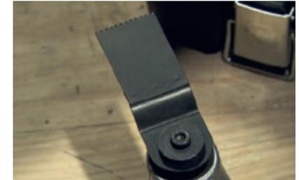
**!** Die Zähne des Sägeblattes sind sehr scharf. Vermeiden Sie es, sie während der Montage und speziell während der Arbeit zu berühren. Spannen Sie das Werkstück ein oder befestigen Sie es gut, bevor Sie zu schneiden beginnen.
