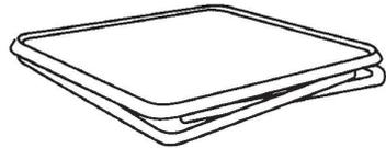
Zusammengeklappt – Standfüße um 90 Grad nach innen klappen, bis diese einrasten.
