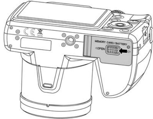
2. Entriegeln und öffnen Sie das Akku-/Speicherkartenfach an der Unterseite der Kamera.
