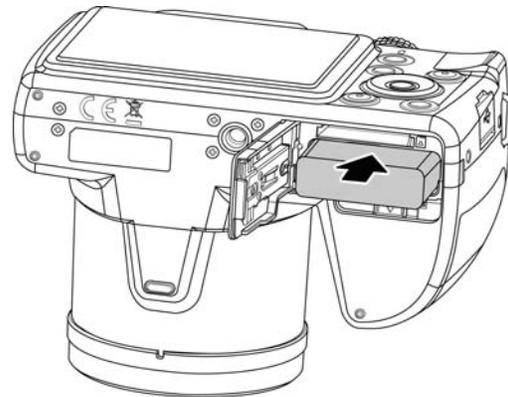
4. Schließen und verriegeln Sie das Akku/Speicherkartenfach. Um zu vermeiden, dass der Akku herausfällt, stellen Sie bitte sicher, dass das Fach fest verriegelt ist.
