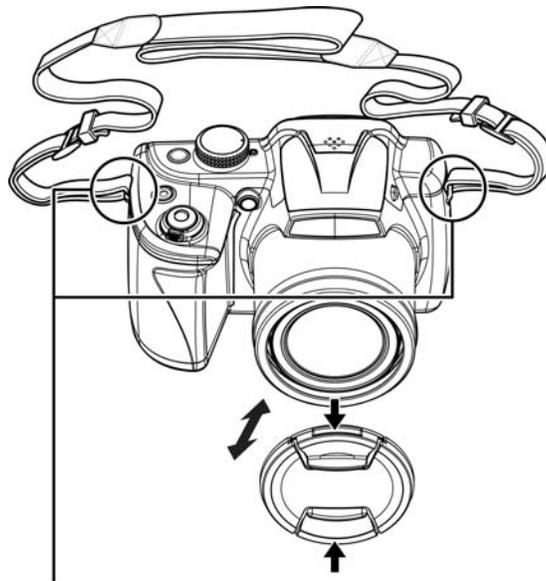
Bitte stellen Sie sicher, dass der Tragriemen an zwei Stellen befestigt ist.
